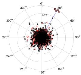
Fig. 20. Bearing with spectrum width  $B=4\,\mathrm{kHz}$  ( $f_0=100\,\mathrm{Hz},\,2d=0.2\,\mathrm{m},\,f_s=150\,\mathrm{kHz},\,T=0.2\,\mathrm{s},\,\mathrm{SNR}=-7\,\mathrm{dB},\,N=10000,\,\alpha=30^\circ$ ).
